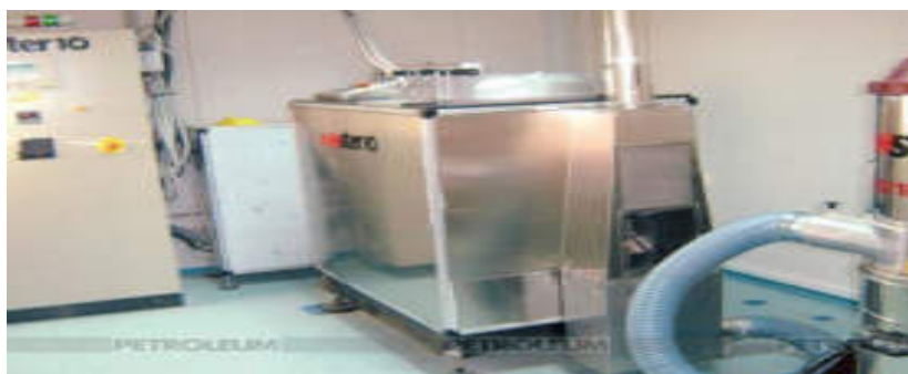
Рисунок 1. Обеззараживание медицинских отходов на установке Newster 10
